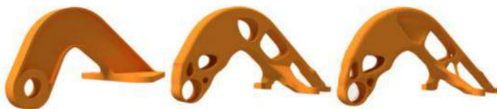
სურ. 21 ტოპოლოგიურად ოპტიმიზებული სამაგრი
